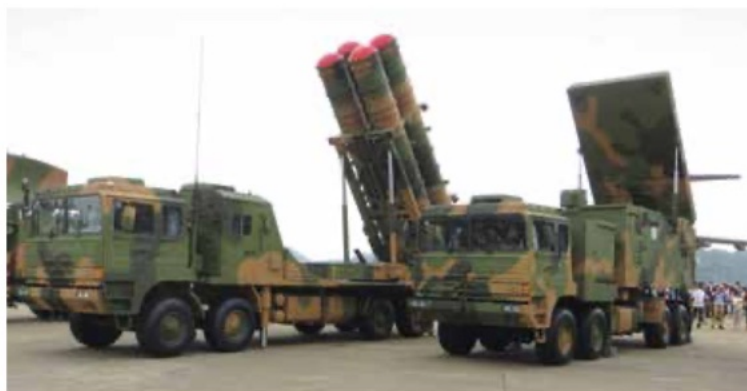
▲ FK-3 Luchtdoelraket systeem met rechts daarvan een HT-233 (TA5501A) vrachtwagen met "Flaplid" luchtverdedigingsradar
