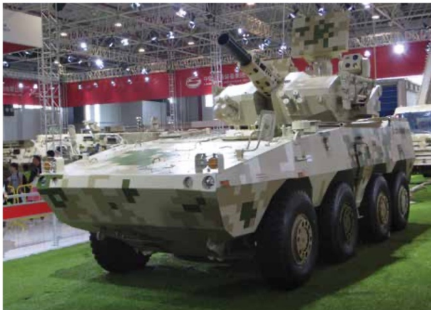
► VN-1 (CS/SA-5) met 6 30mm lopen en 4 FN-6 lucht-doelraketten
