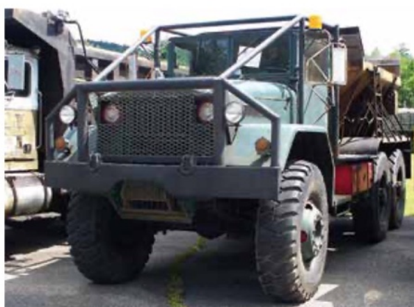
◀ Een omgebouwde M123 een een soort strooibak achterop. Het lijkt erop dat daarbij ook de lier is verdwenen. De foto is genomen in New Hampshire (VS)
